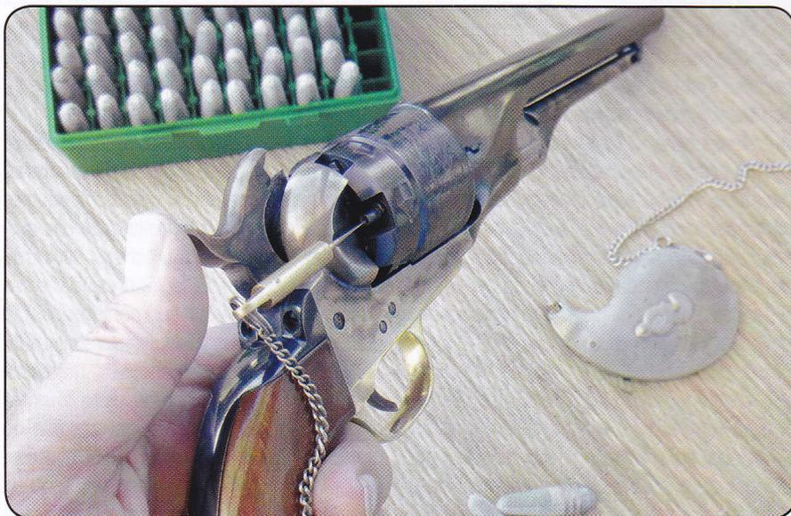
**Avec les cheminées à lumière de 0,5mm seulement, et même en cas d'utilisation d'amorces « magnum », le départ du coup n'est pas garanti à cent pour cent si l'on ne prends pas soin, soit de déchirer le fond des cartouches avant introduction, soit de les percer à travers les cheminées avant amorçage.**
