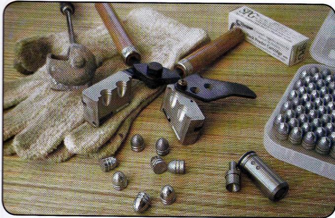
Notre moule Lee 44-200-1R, quelques projectiles bruts de coulée, la matrice de calibrage en .454 pouce, le pousoir de balles et un boîte de projectiles graissés / calibrés sur la droite. En fond un bâton de graisse SPG dans son emballage.
