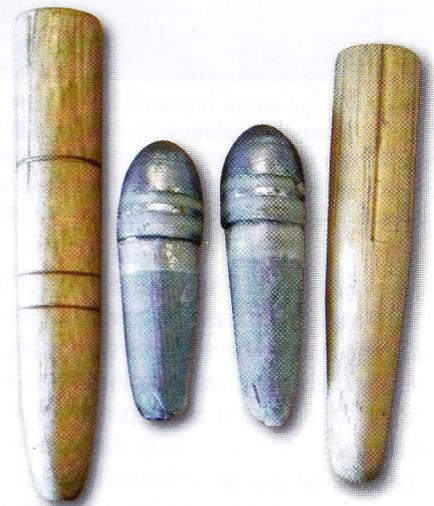
A gauche, une cartouche ancienne fabrication, à droite, la nouvelle version plus conique et les mandrins correspondants. La conicité accrue améliore notablement l'introduction dans les revolvers Colt 1860 Army.
