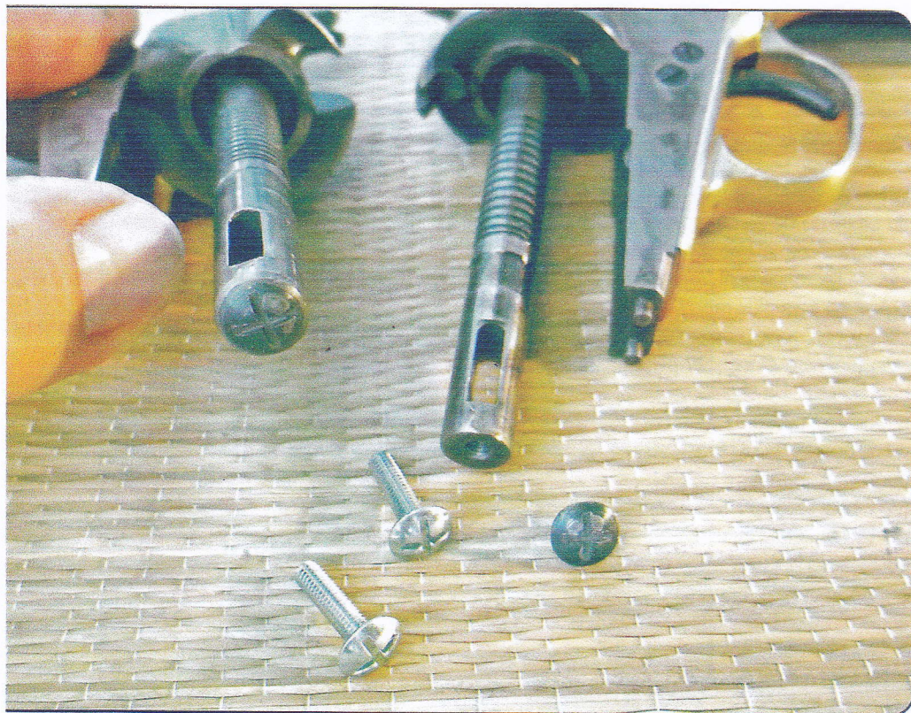
A gauche, l'axe de barillet rallongé avec son boulon en place. A droite, l'axe percé et taraudé avec son boulon démonté. Au premier plan deux boulons « poêliers » du même type que ceux utilisés pour cette modification.
