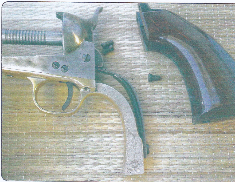
Détail du grand ressort renforcé par adjonction d'une portion de ressort du même modèle. Associé à l'utilisation de cheminées à lumière de 0,5 mm, cette modification limite encore les fuites vers l'arrière tout en assurant une percussion beaucoup plus franche.
