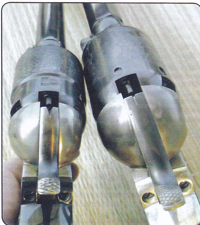
A droite, le cran de mire agrandi de l'un de nos 1860 Army. A gauche, la taille d'origine du dit cran sur une réplique Uberti de Colt Dragoon. Ceux qui, comme nous, ont malheureusement la vue qui baisse, comprendront tout de suite l'intérêt de la chose...
