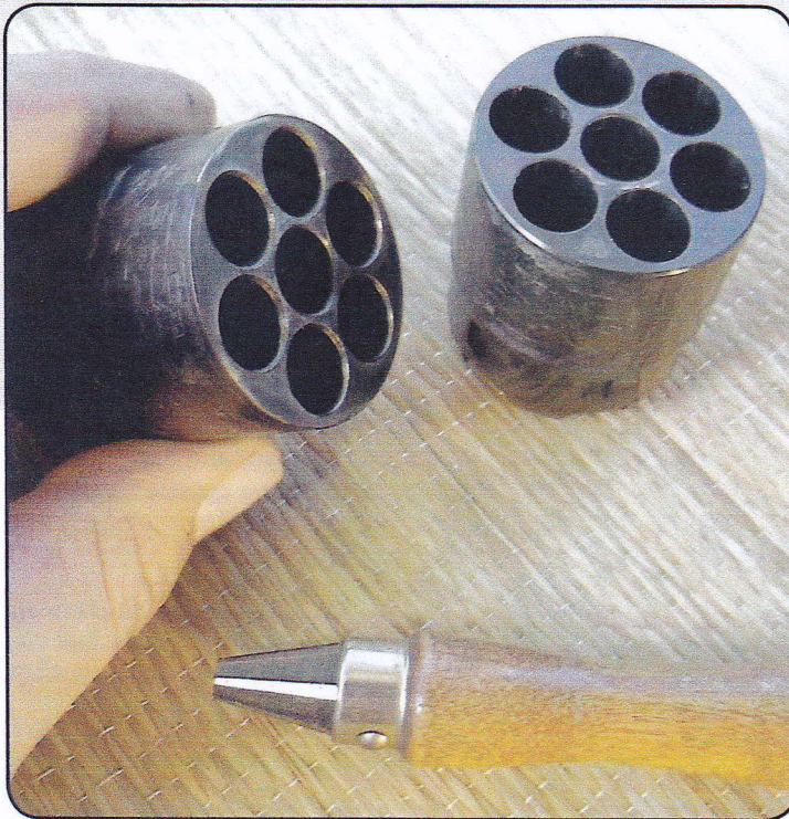
A gauche le barillet après chanfreinage à l'aide de la fraise VLD Lyman visible au premier plan. A droite un barillet non modifié. Le dit chanfreinage facilite l'introduction des projectiles et évite qu'ils soient rabotés lors de cette opération.
